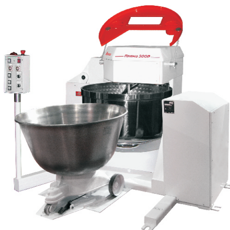
Тестомесильная машина «Прима-300Р» с загрузчиком опары
