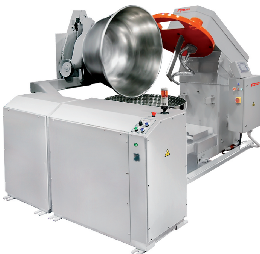
Загрузка опары из дежи Т1-ХТ2Д 330 л. в дежу автомата выгрузки, работает загрузчик опары
